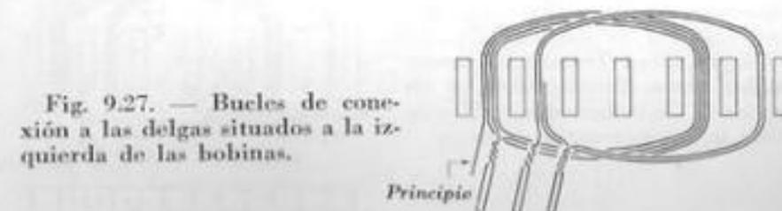
Fig. 9.27. — Bucles de conexión a las delgas situados a la izquierda de las bobinas.
