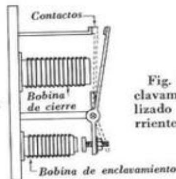
Fig. 8.63. — Contactor de enclavamiento con dos bobinas, utilizado en arrancadores de corriente límite.
