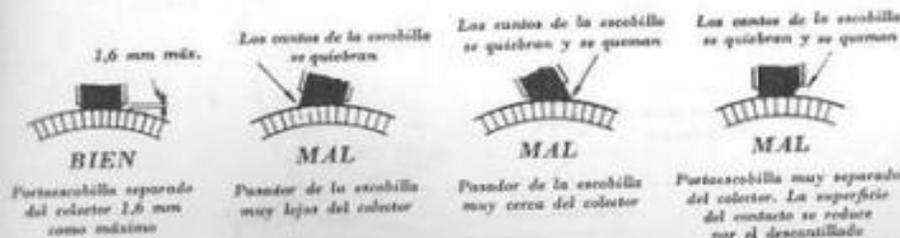
Fig. 7.62. — Posiciones correctas e incorrectas de las escobillas.
