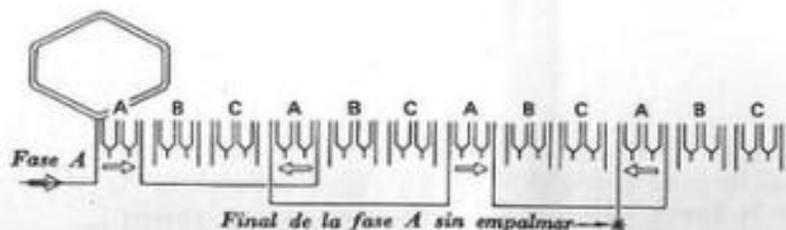
Fig. 4.38. — Conexión de los grupos que componen la fase A.
