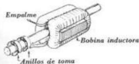
Fig. 10.32. — Rotor de un sincronizador.
