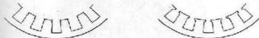
Fig. 4.10. — Tipos de ranuras estáticas propias de los motores trifásicos: A) ranuras abiertas; B) ranuras semicerradas.
