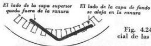
Fig. 4.24. — Disposición inicial de las bobinas en el estator.
