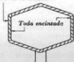
Fig. 4.13. — Bobina hexagonal completamente encintada, usada en estatores provistos de ranuras abiertas.
