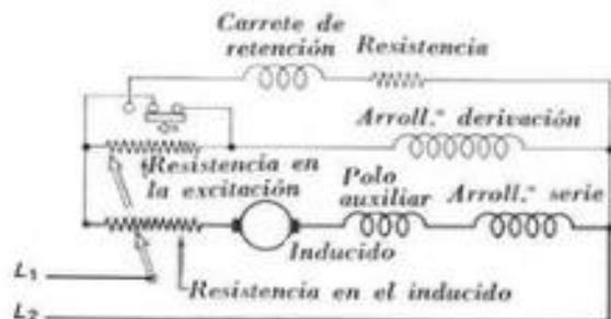
Fig. 8.11. — Esquema simplificado de la figura anterior.
