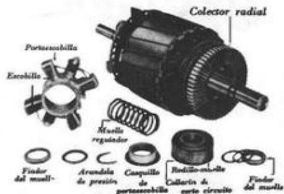
Fig. 3.5. — Rotor parcialmente desmontado y piezas que constituyen el mecanismo centrífugo (Wagner Electric Company).
