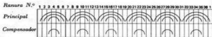
Fig. 3.55. — Diagrama de pasos de un motor de repulsión hexapolar provisto de arrollamiento de compensación. Obsérvese la disposición de las bobinas del arrollamiento de compensación con respecto a las del arrollamiento principal. Por regla general, el arrollamiento de compensación es el primero que se aloja en las ranuras.
