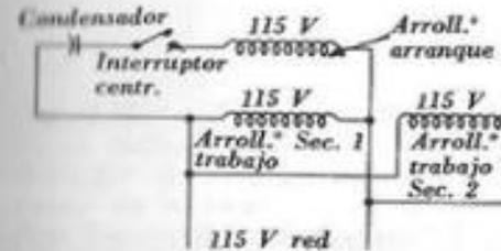
Fig. 2.25. — Esquema de conexión de los arrollamientos del motor de la figura 2.24 para una tensión de servicio de 115 V. Las dos secciones del arrollamiento de trabajo están conectadas en paralelo.
