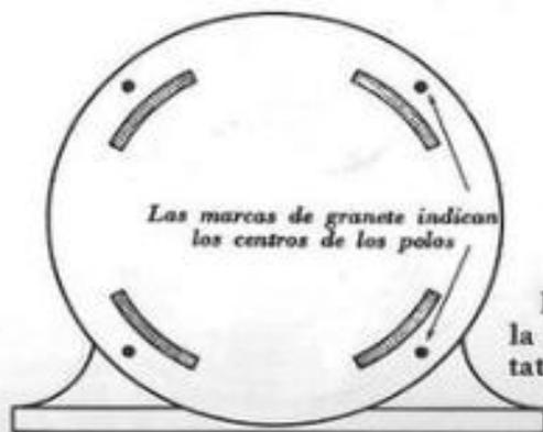
Fig. 3.20. — Manera de señalar la posición de los polos en el estator de un motor de repulsión.
