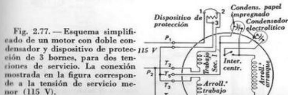
Fig. 2.77. — Esquema simplificado de un motor con doble condensador y dispositivo de protección de 3 bornes, para dos tensiones de servicio. La conexión mostrada en la figura corresponde a la tensión de servicio menor (115 V).
