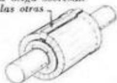
Fig. 6.111. — Delga saliente en un colector.
