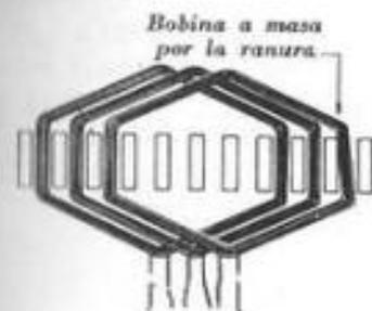
Fig. 4.117. — Para localizar la bobina con contacto a masa, se desueldan los empalmes que unen todas las del grupo defectuoso y se comprueban separadamente.
