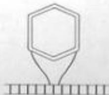
Fig. 6.27. — En un arrollamiento ondulado los terminales de una misma bobina divergen por estar conectados a delgas bastante distanciadas.
