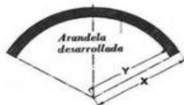
Fig. 6.105. — Contorno de una arandela desarrollada sobre un plano, completado hasta formar un sector circular.
