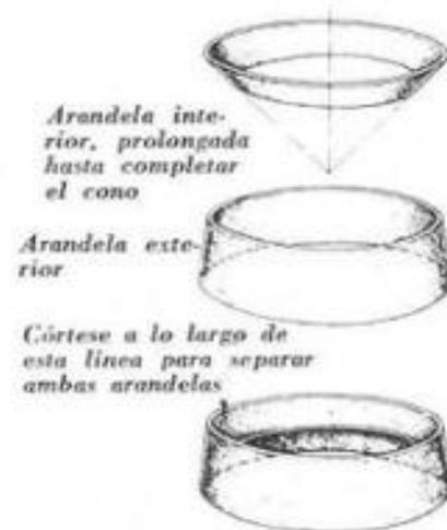
Fig. 6.103. — Manera de utilizar la antigua arandela interior de mica, una vez cortada y desarrollada sobre un plano, para trazar el contorno de la nueva.
