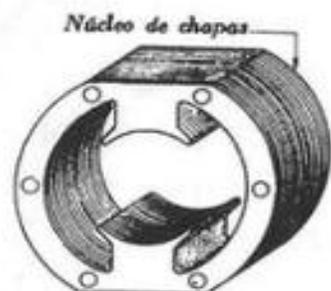
Fig. 9.3. — Núcleo estático de un motor universal bipolar.
