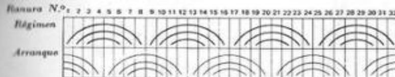
Fig. 1.19. — Manera de anotar los pasos de las bobinas en un motor de 4 polos y 32 ranuras. Si así se desea, puede indicarse también el número de espiras de cada bobina junto a la misma.
