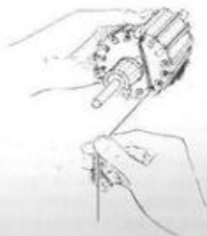
Fig. 6.5. — Un inducido pequeño puede sujetarse con una mano mientras se bobina con la otra.
